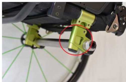
Pour les fauteuils à essieu réglable en hauteur assurez-vous que l'extrémité du plongeur de réglage de la hauteur sol/siège, ne dépasse pas la platine de fixation de la barre de carrossage (voir à droite dans le cercle rouge). Si les plongeurs sont trop longs, il est en principe possible de les recouper, car le surplus de longueur ne contribue en rien à la solidité du cadre. Toutefois, ne modifiez rien sans accord écrit préalable du fabricant du fauteuil roulant.
