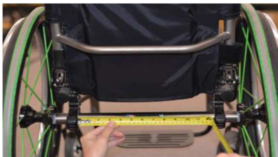
Cette image illustre la prise de mesure de la barre de carrossage, soit la longueur disponible de la barre de carrossage dégagée de tout obstacle
